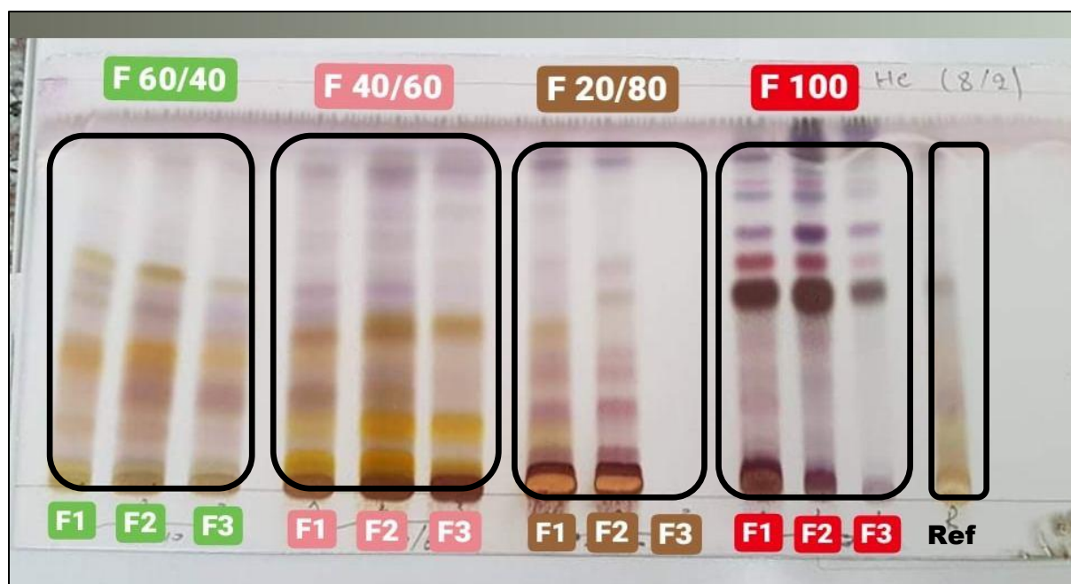
Figure 32: Chromatogramme des fractions de la VLC de l'extrait brut (Système d'élution : \text{CHCl}_3 : MeOH (8 :2)).
